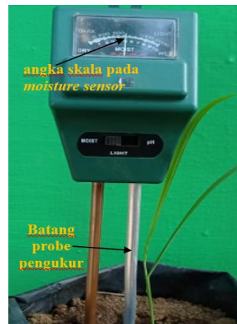
Gambar 1. Pengukuran kelembaban tanah dengan soil moisture sensor
